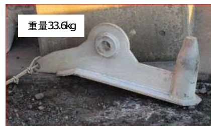
図3: 落下した部品(ロックピン)
