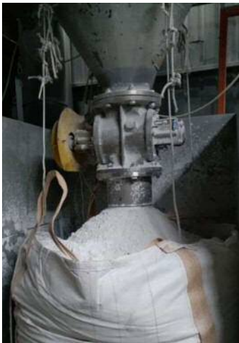
フレコンが満杯になり、 排出口が粉詰まりしていた
