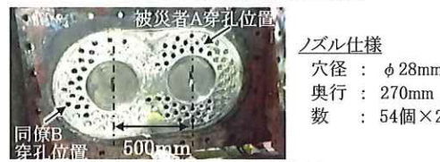
写真2. 被災時のノズル穿孔位置
