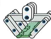
図3. 結束機の機構(今回はアーム先端の爪部がバンドにかみ込み)
