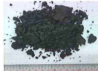
図3 集塵ダクト内ダスト
